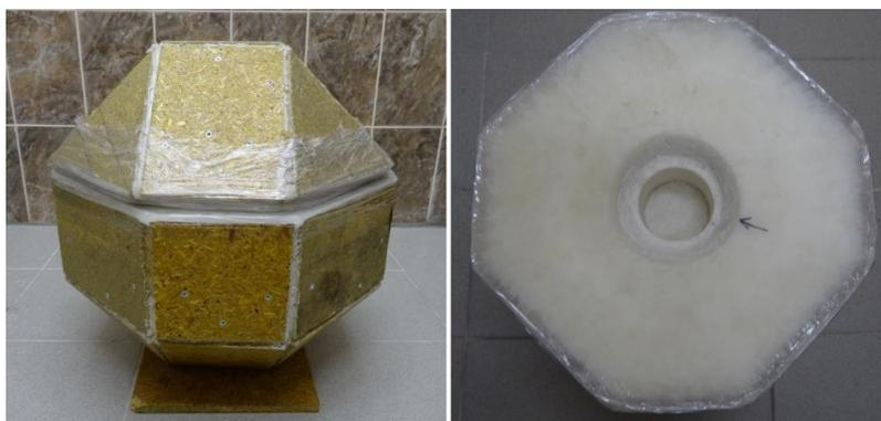
Рис.1. Конструкция для инкубации биологических объектов в условиях воздействия высокоэнергетической нейтронной компоненты вторичных космических лучей
